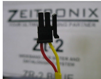
Conector de la sonda EGT (Amarillo: termopar +) (Rojo: termopar -)
