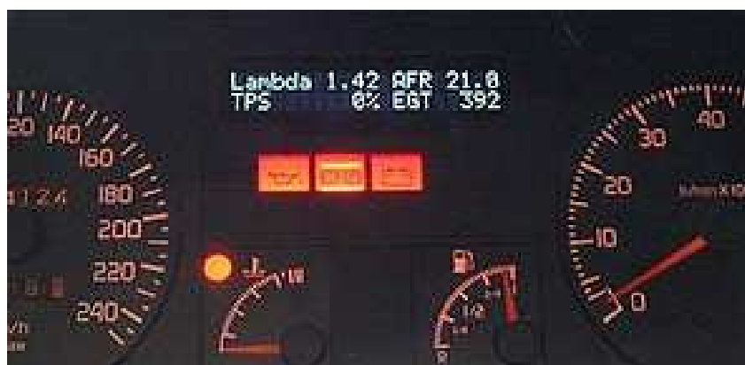
Display LCD integrado en un cuadro Renault.
